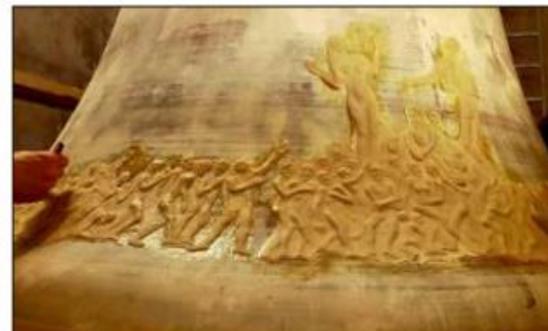
Die unteren Zierelemente der Glockenvorderseite wurden ebenfalls mit Wachs auf die „falsche Glocke“ aufgebracht.
