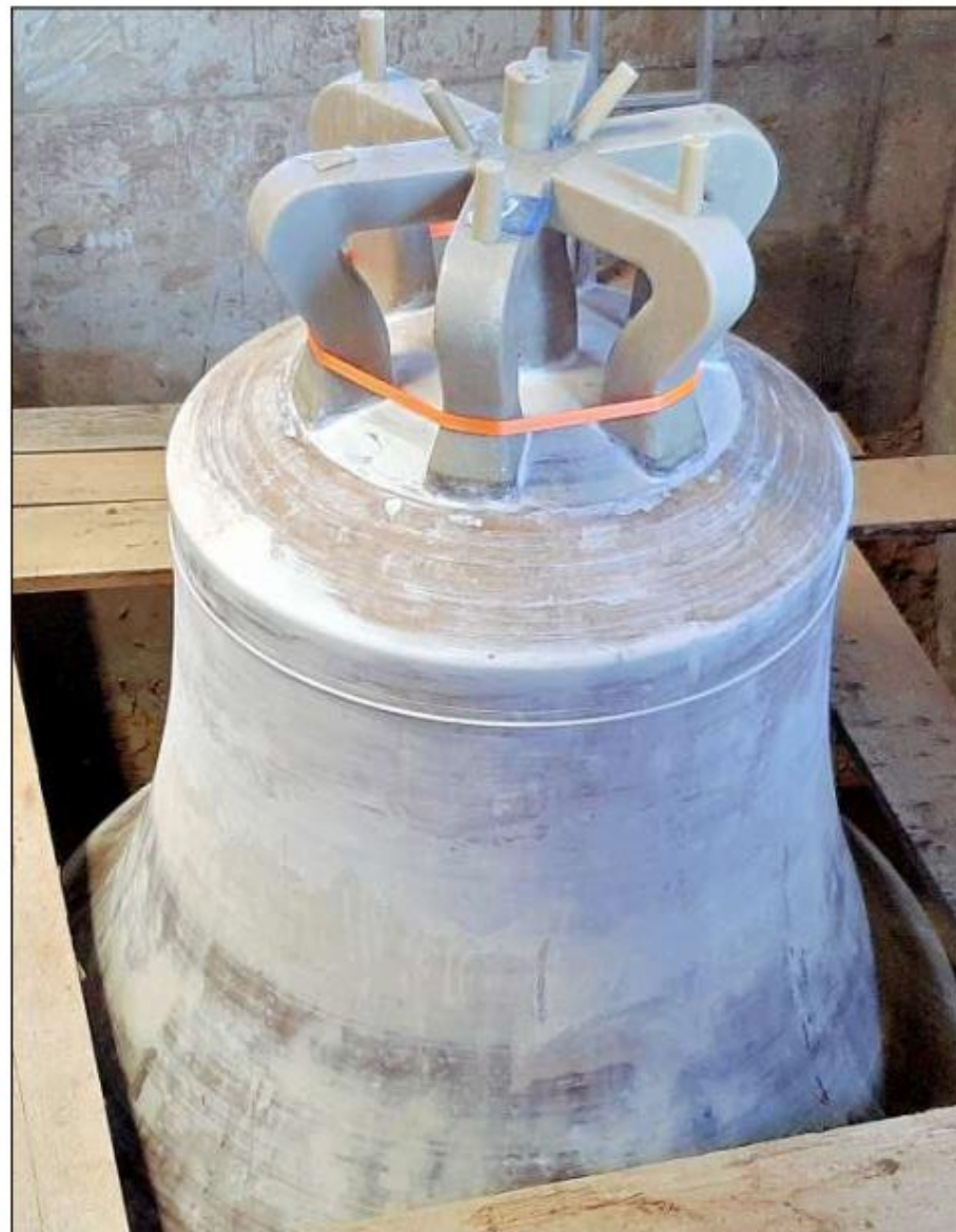
Die eingerüstete „falsche Glocke“ mit Krone. Die sechsarmige Glockenkrone, die sowohl Zier- als auch Haltefunktion hat, war von der Künstlerin der Glockengießerei Bachert, Annette Weiß, schon aus Wachs geformt und mit der Glockenform verbunden worden.
